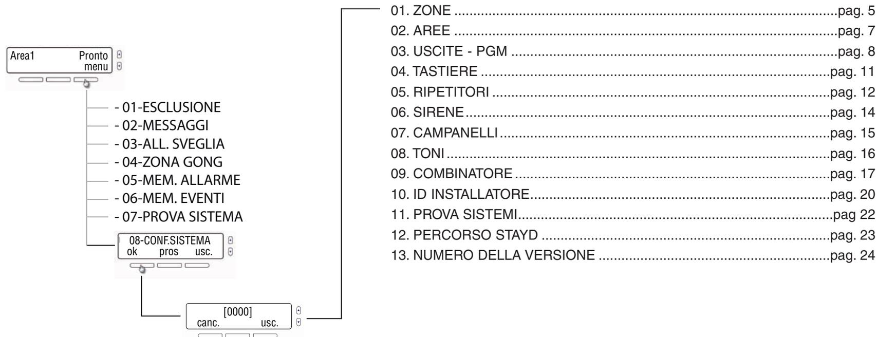
NOTA: Si può accedere al menu del sistema (CONF. SISTEMA) usando i tasti freccia oppure digitando 08. Dopo l'accesso, digitare il codice di default dell'installatore
