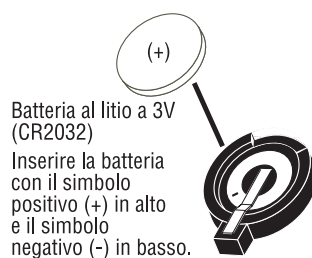
Figura 11: Cambio della batteria dell'orologio RTC
