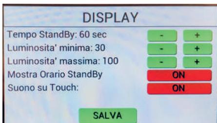
Per una buona visualizzazione dell'orologio in stand by, si suggerisce di impostare al massimo il valore di luminosità
