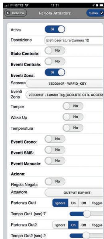
Il riconoscimento del Tag abbinato a questo utente, attiva il relè 2, temporizzato, della centrale
