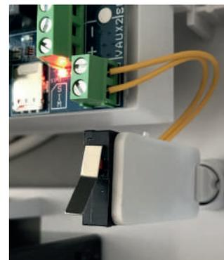
NOTA: il micro pulsate SW1 sulla scheda si trova in parallelo allo switch del tamper
