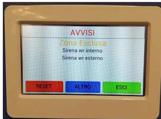
Per resettare gli avvisi premere il tasto **RESET** e digitare il codice utente che se non cambiato di default è " **1 2 3 4** " seguito dal tasto **INVIO**. Altrimenti al prossimo inserimento e disinserimento della centrale vengono resettati automaticamente.
